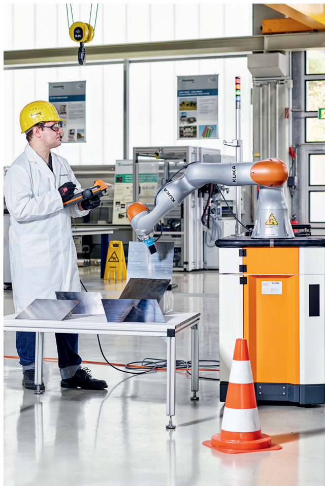
Bild 1. OPC UA-basierte, robotergestützte Materialcharakterisierung von Blechen mittels mikromagnetischer Prüfverfahren
